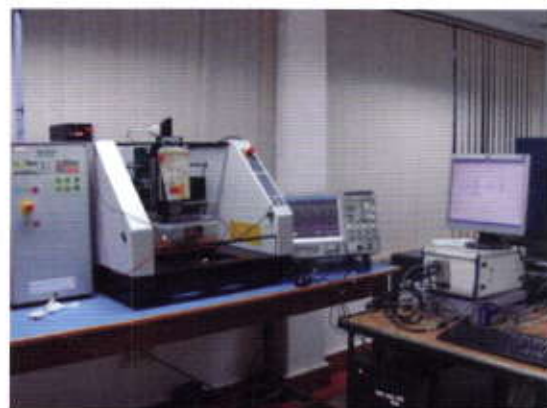
चित्र संख्या ४ : सीएमईआरआई में विकसित माइक्रो ईडीएम (μ-EDM)
